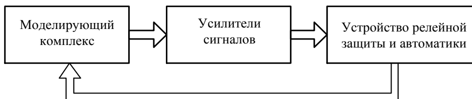
Рис. 1. Схема подключения ВМК РВ ЭЭС к устройству релейной защиты
